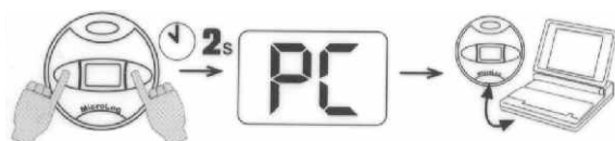
Przesyłanie danych do komputera PC przez port IRDA
